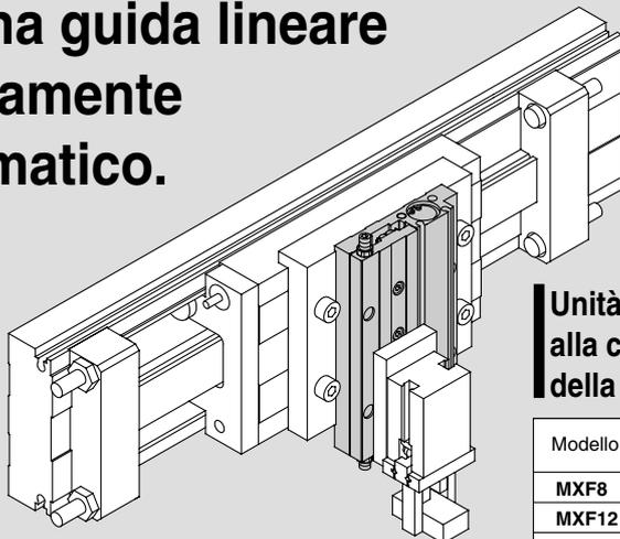
Unità piatta e compatta grazie alla costruzione del cilindro e della guida in parallelo.
