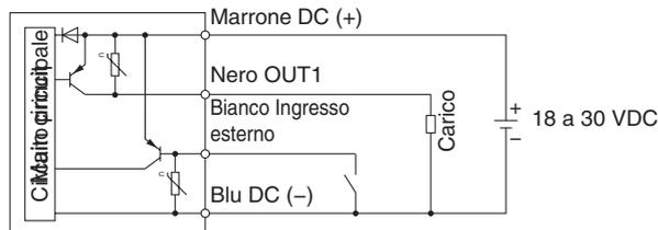
Max. corrente di carico: 80 mA, Caduta di tensione interna: 1.5 V max.
