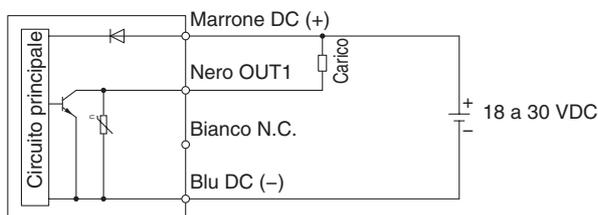
Max. tensione applicata: 30 V, Corrente di carico massima: 80 mA, Caduta di tensione interna: 1.5 V o inferiore
