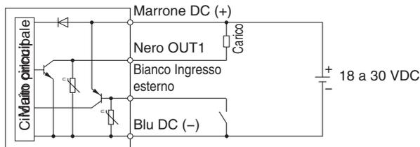
Max. tensione applicata: 30 V, Corrente di carico massima: 80 mA, Caduta di tensione interna: 1.5 V o inferiore
