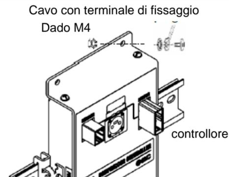
In caso di montaggio su guida DIN
