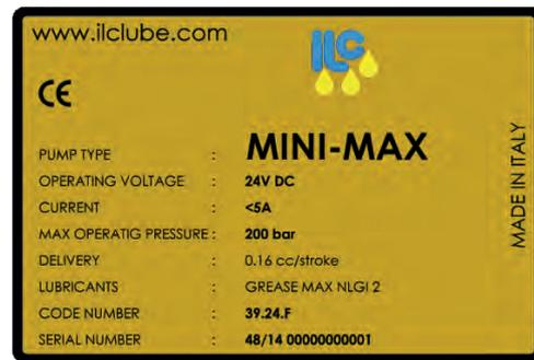
Nel lato posteriore della pompa è posta una targhetta su cui è riportato il codice del prodotto, la tensione di alimentazione e le caratteristiche di base.
